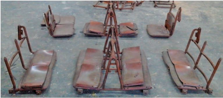
Nach der ersten Säuberung folgte die Zuordnung der Sitze zur ehemaligen Position im Wagen. Hinter dem Gelenk, ab der dritten Tür, waren die Sitze bis zum Schaffnerplatz erhalten. So entstand die Idee, ein kleines Fahrzeugsegment mit originalen Teilen wiederaufstehen zu lassen. (André HELLMUTH, 2016-03-08)
