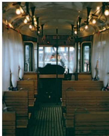
Zum Kieler Umschlag am 7. Februar 1976 kam der „neue“ Wagen zu seinem ersten Einsatz. Gut zu erkennen ist die nicht vorhandene Abtrennung zur Plattform, an deren Stelle nur zwei kleine Scheiben über den Einzelsitzen bei dem Wiederaufbau eingebaut wurden. (Peter HOLTORFF, 1976-02-07)
