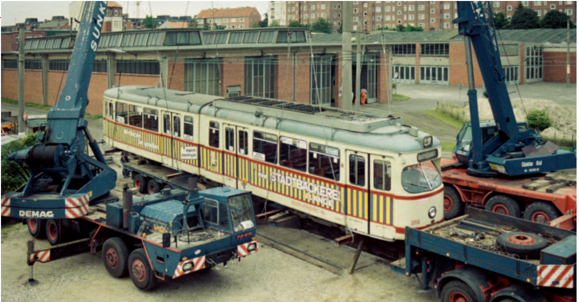
Am 2. August 1984 hoben zwei mobile Kräne den Gelenktriebwagen zum Abtransport auf einen Sattelschlepper. Für den Beiwagen war der Aufwand geringer, und es reichte ein Kran für die Verladung aus. Schauen wir rückblickend auf den Aufwand und die Kosten der Überführung in das Museum, so wäre eine nachhaltigere Aufbewahrung wünschenswert gewesen. (Peter HOLTORFF 1984-08-02)
